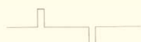
Korte pulsvormige wisselstroom, zoals bij de huidige elektroshockapparaten Thymatron en MECTA.
